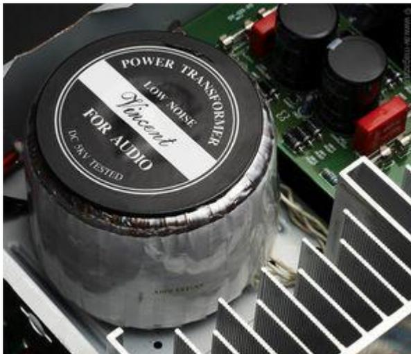
Extrem sauber ist die Stromversorgung des SV-123 aufgebaut. Basis bildet ein rauscharmer Ringkerntransformator
