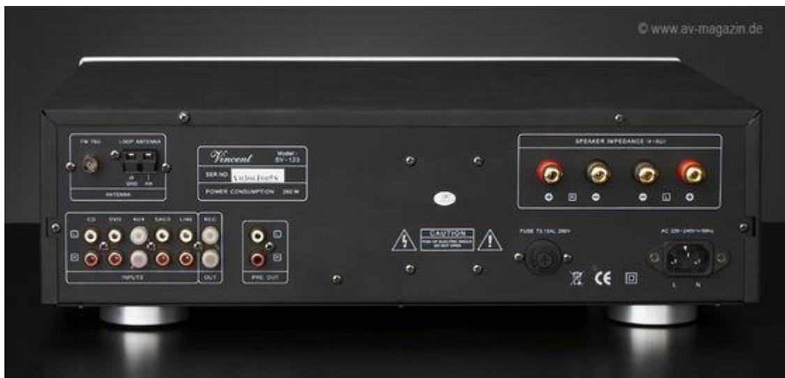
Neben Cinchein- und Lautsprecherausgängen bietet der Vincent einen Vorverstärkerausgang zum Anschluss eines aktiven Subwoofers oder einer separaten Endstufe
