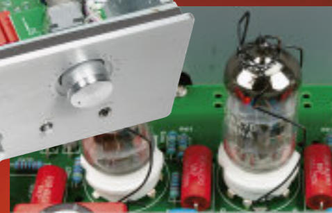
Auch beim SV-226 Mk II kommt ein extrem potenter Ringkerntrafo zum Einsatz, der die ganze Gehäusehöhe einnimmt. Vorne ist die Röhrenvorstufe zu sehen
