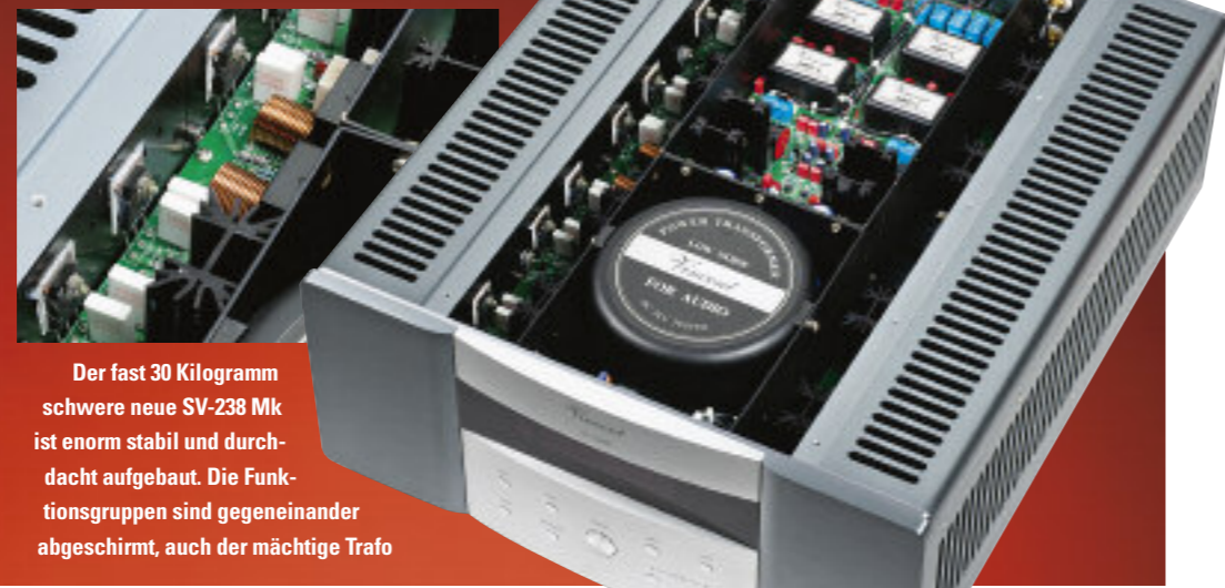
Links oben: Die extrem breitbandigen, rauscharmen Amp-1-Eingangsmodule stammen aus der Vorstufe SA-93 plus und rücken nahe an die Eingänge heran. Rechts oben: sechzehn Leistungsgruppen sind gegeneinander abgeschirmt, auch der mächtige Trafo
