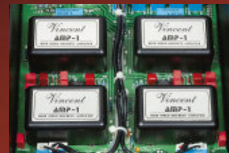
Links oben: Die extrem breitbandigen, rauscharmen Amp-1-Eingangsmodule stammen aus der Vorstufe SA-93 plus und rücken nahe an die Eingänge heran. Rechts oben: sechzehn Leistungsgruppen sind gegeneinander abgeschirmt, auch der mächtige Trafo
