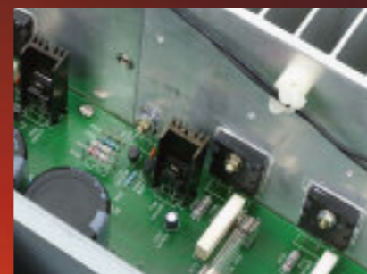
Beim SV-226 Mk II werden die Lautsprecher von je zwei Pärchen Leistungstransistoren, also vier Stück je Kanal, angefeuert. Die strikte, äußerst sinnvolle räumliche Trennung von Vorstufe und Leistungsteil findet sich auch in diesem Gerät wieder
